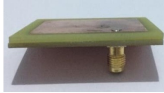
Gambar 9. Hasil Fabrikasi Antena Substrat Ganda
