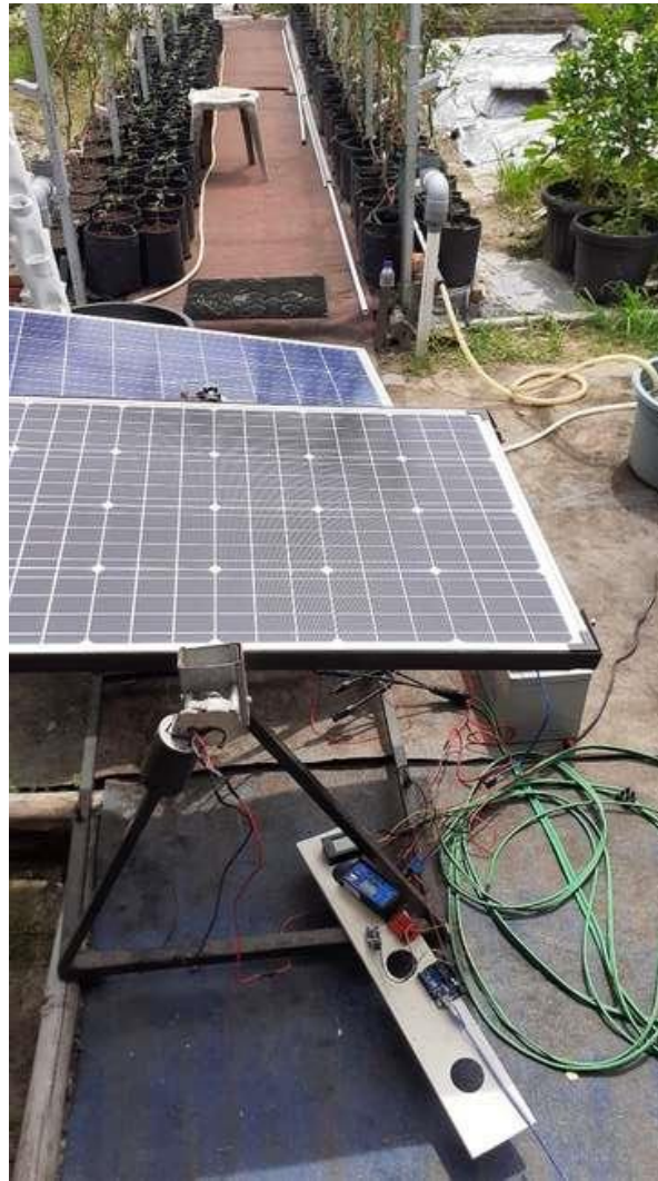
Gambar 14. Sistem Penyiraman Otomatis Tomat Ceri berbasis Real Time Clock (RTC) dengan Memanfaatkan Tenaga Surya
