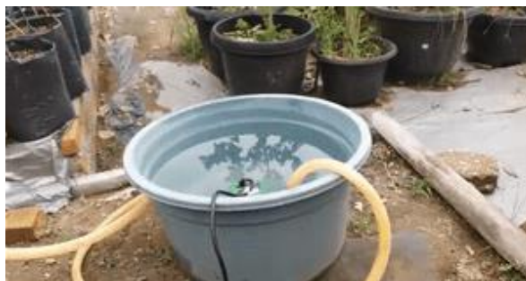
Gambar 9. Pompa Celup DC dengan Daya dari Panel Surya
