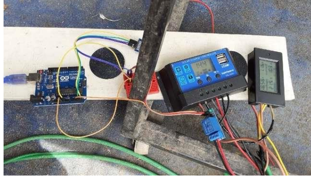
Gambar 6. Rangkaian Elektronika dengan Supply Daya dari Panel Surya
