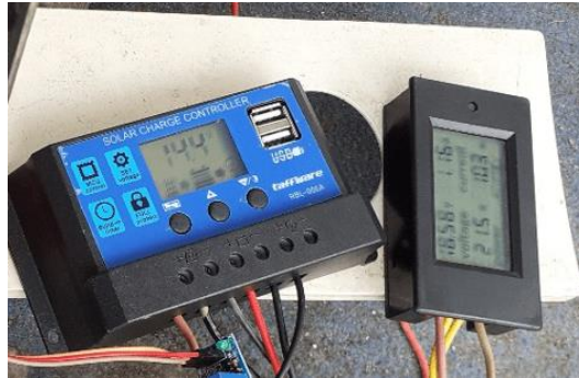
Gambar 8. Perolehan Data dari SCC dan Energi Meter pada Kondisi Tanpa Beban
